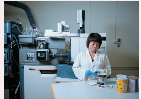
▲ 修复人员正准备油漆样本，以气相色谱质谱联仪测量挥发性气体的含量和性质。
