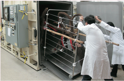
▲ 修复人员合力把大坑火龙头部放进氮气灭虫室作灭虫处理
